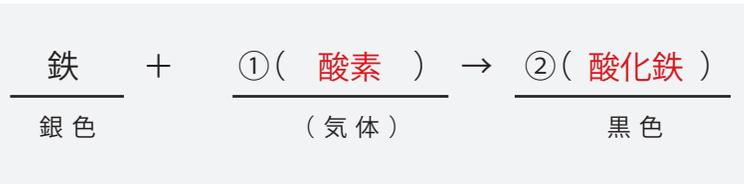
スチールウールを加熱すると、空気中の③(酸素) と結びつき、光や熱を出しながら燃え、黒くてもろい④(酸化鉄) ができる
